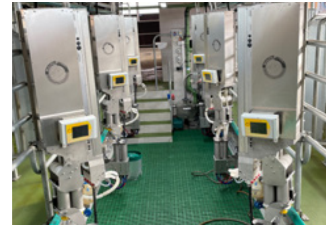
Der Zwei-mal-Dreier Auto-Tandem-Melkstand garantiert, dass die behornten Kühe ungestört gemolken werden können.
